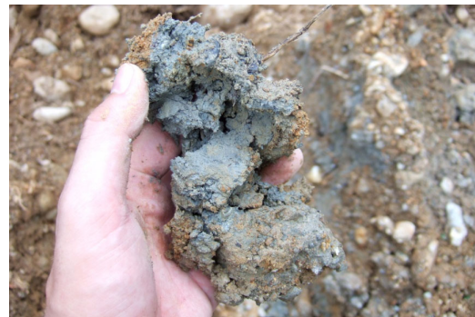
写真-10 崩積土先端付近の粘性土 24)
